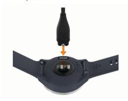
3 Collegare il cavo USB a una fonte di alimentazione per accendere il dispositivo (*Caricamento del dispositivo*, pagina 10).
