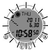
L'afficheur de la montre est éclairé pour être mieux visible à l'obscurité. Le commutateur d'éclairage automatique de la montre s'active lorsque vous tournez la montre vers votre visage, et à ce moment l'afficheur s'éclairc.
