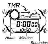
O timer pode ser definido dentro de uma faixa de um minuto a 24 horas. Um alarme soa quando a contagem regressiva atinge zero. O timer também tem uma função de repetição automática e um gerador de bipes que sinaliza o progresso da contagem regressiva.
