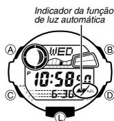
Este relógio tem um painel EL (eletroluminescente) que faz que o mostrador inteiro se ilumine para uma leitura fácil no escuro. A função de luz automática do relógio acende a iluminação do mostrador automaticamente quando você inclina o relógio para o rosto.
