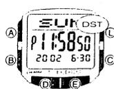
Halten Sie den Knopf 'C' für etwa zwei Sekunden in dem Zeitnehmungs-Modus gedrückt, um zwischen der Sommerzeit (DST wird angezeigt) und der Standardzeit (DST wird nicht angezeigt) umzuschalten.
